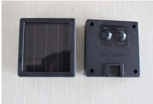
此系列基本配置为太阳能板2V, 电池1.2V, 输出3V, 适用于各类并联接法灯串, 120L以内都适用
